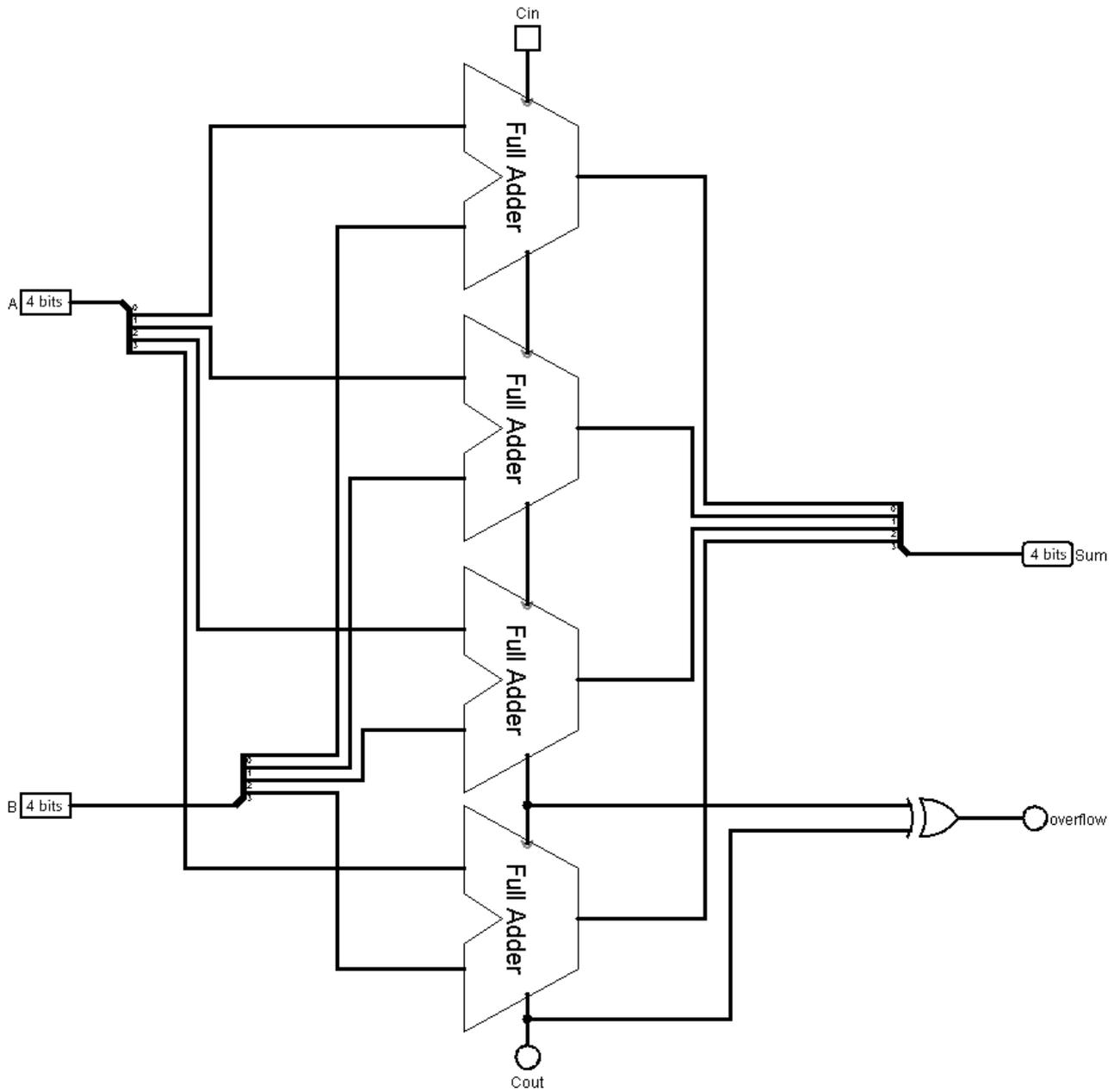
**Remarque :** le bit du overflow est calculé par une porte XOR sur l'entrée de la retenue et la sortie de la retenue du Full-Adder du dernier bit.
