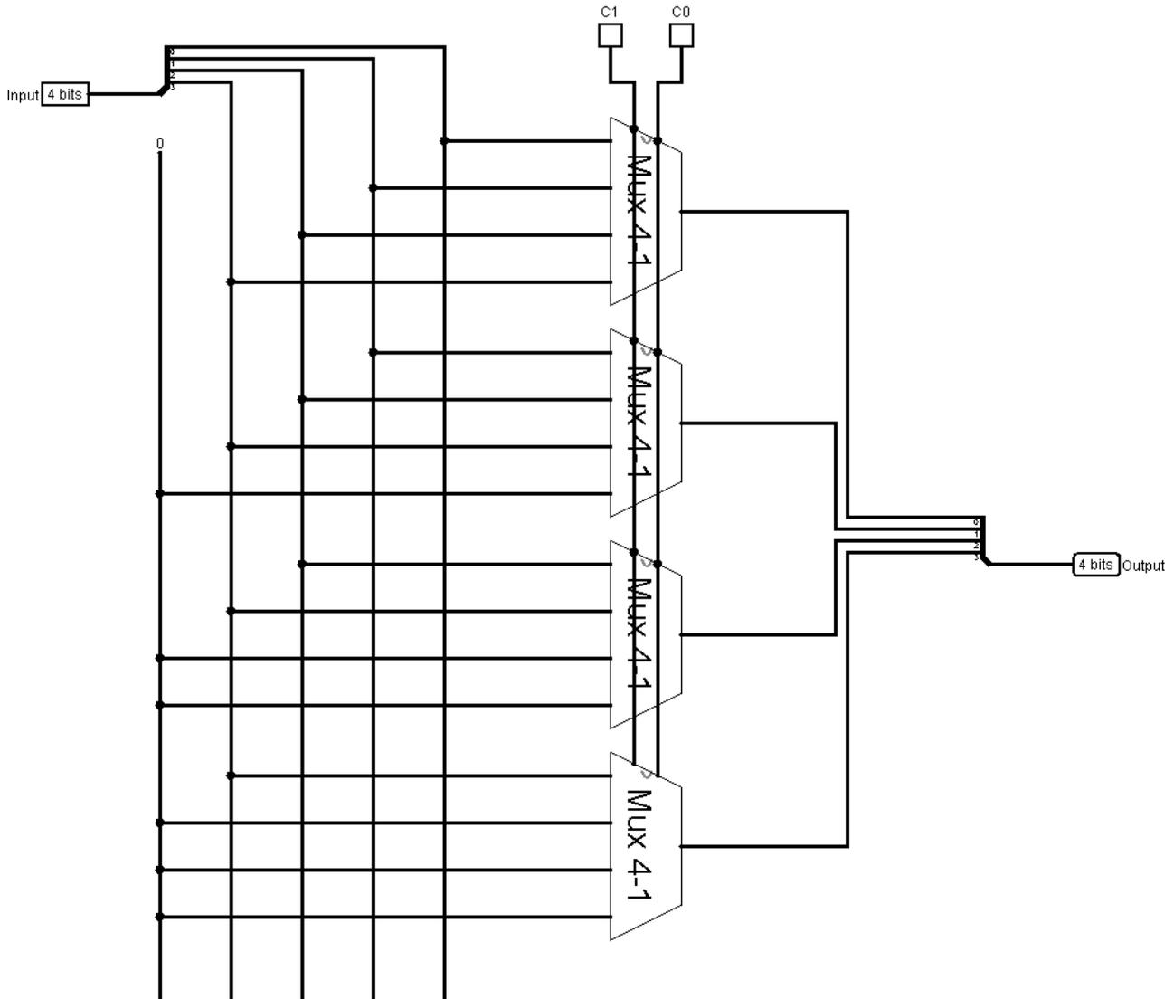
**Remarque :** Le Shifteur a besoin de 2 bits de commandes pour pouvoir faire un décalage sur 0 bit, 1 bit, 2 bits ou 3 bits. Dans notre processeur on aurait besoin que du décalage de 1 bit, ainsi on va fixer les commandes dans l'UAL après des Shifter par des constantes.
