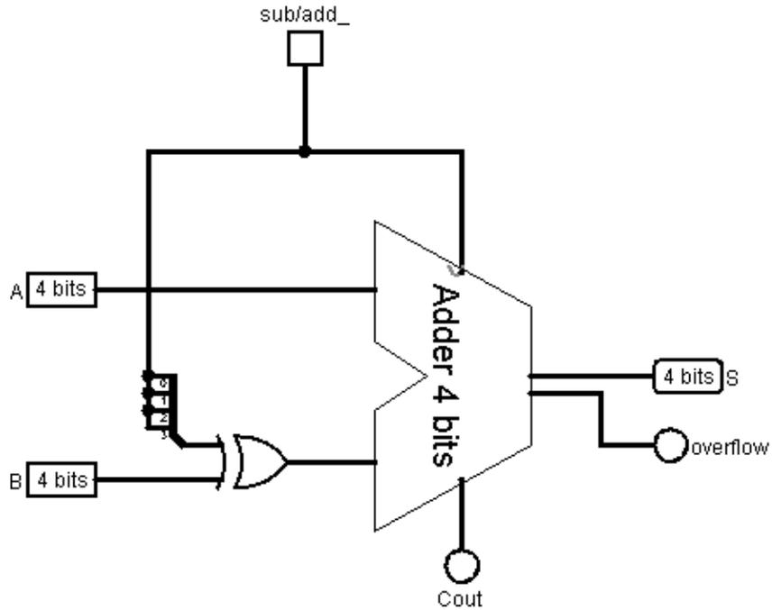
**Remarque :** La commande en haut permet de choisir entre l'addition et la soustraction,  $\overline{\text{add\_}}$  signifie  $\overline{\text{add}}$  donc le 0 pour la commande fait l'addition, et 1 fait la soustraction parce qu'il n'y a pas de bar sur  $\text{sub}$ .
