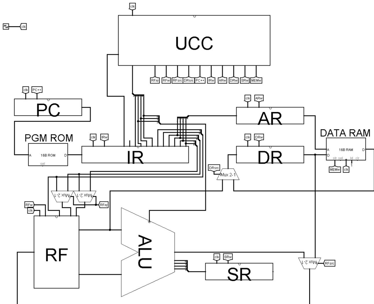
**Remarque :** La RAM doit avoir l'entrée séparée de la sortie, et ça c'est un paramètre à modifier dans ses options, c'est `separate load and store` dans Data interface. Pour la commande de la RAM en vas implémenter que le signal d'écriture, la lecture est mise à 1.
