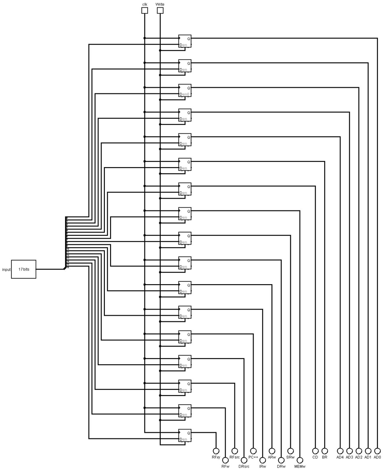
**Remarque :** Le CSR est déphasé d'un demi cycle d'horloge, c'est le NOT qui fait inverser le signal d'horloge pour le CSR, la raison est que les signaux de commande doivent rester stable lors du front montant d'horloge des composants du datapath. CSR fait réellement changer ses valeurs en provenance de la ROM lors du front descendant de l'horloge.
