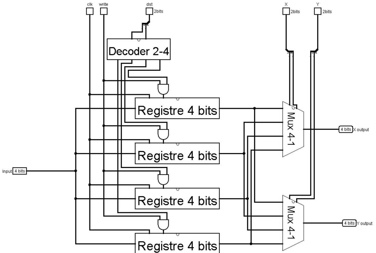
**Remarque :** Pour pouvoir écrire sur un registre on utilise un Decodeur 2-4, il va nous permettre de choisir sur 2 bits un registre parmi les 4 registres. On ajoute un autre signal de commande Write qui va commander l'écriture sur le registre désiré. Une porte AND est utilisée pour affirmer l'opération de l'écriture sur un seul registre.
