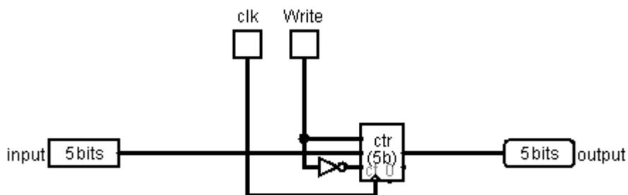
**Remarque 1:** Le CAR aussi comme le PC est un compteur (counter en Anglais), on doit utiliser un compteur de la bibliothèque Logisim. La commande `Write` du CAR permet d'incrémenter +1 si elle est à 0, ou de charger une nouvelle adresse de l'entrée `input`.
