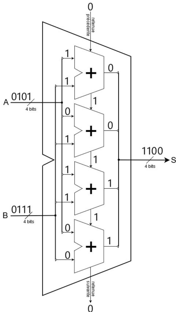
La technique utilisée ici pour construire un additionneur 4-bits à partir de full-adder est appelée la construction en cascade. (0,5 point)
